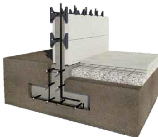
Anclaje a cimentación según proyecto
